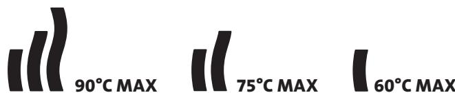
Om man tänker använda radiatorn permanent vid högst 60 °C eller 75 °C bör följande korrigeringssfaktorer tillämpas för uteffekten.
