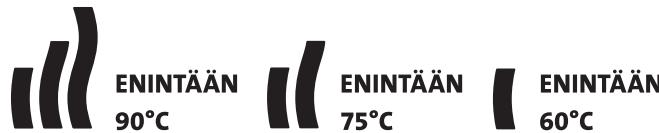
Jos lämmittimen suurimmaksi pintalämpötilaksi rajoitetaan pysyvästi 60 °C tai 75 °C, seuraavat korjauskertoimet on otettava huomioon.
